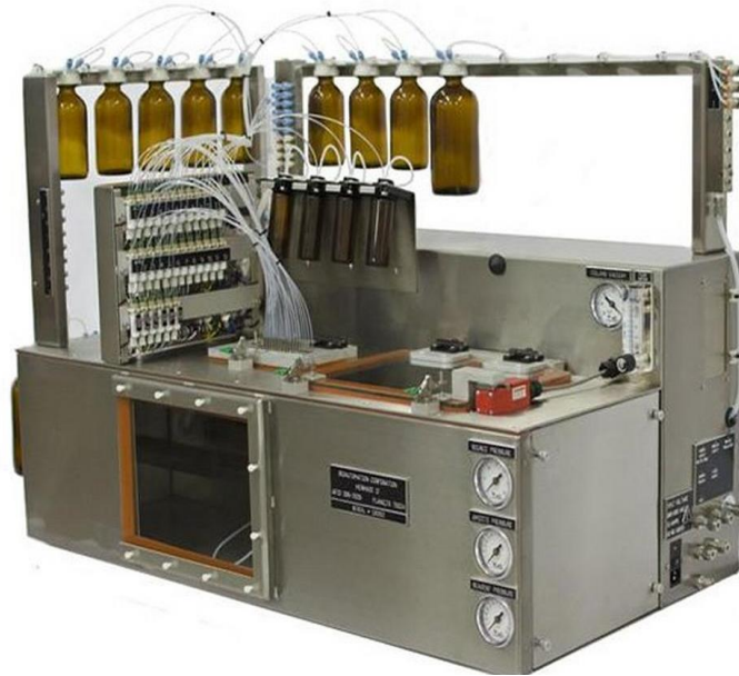
Рис. 5. Синтезатор олігонуклеотидів MerMade 12 призначений для синтезу олігонуклеотидів (ДНК, РНК)
